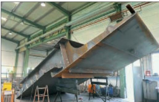
13. kép: Pályalemez üzemi előregyártása
