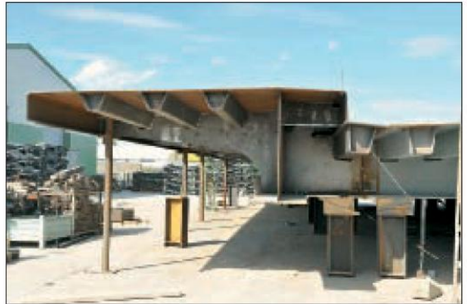
14. kép: Pályatáblák előszerelése (próba illesztése) az üzemi szerelőtéren
