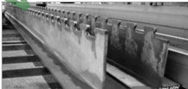
7. ábra: „Felezett” hengerelt „I” szelvény tartóbetétes hidakhoz
