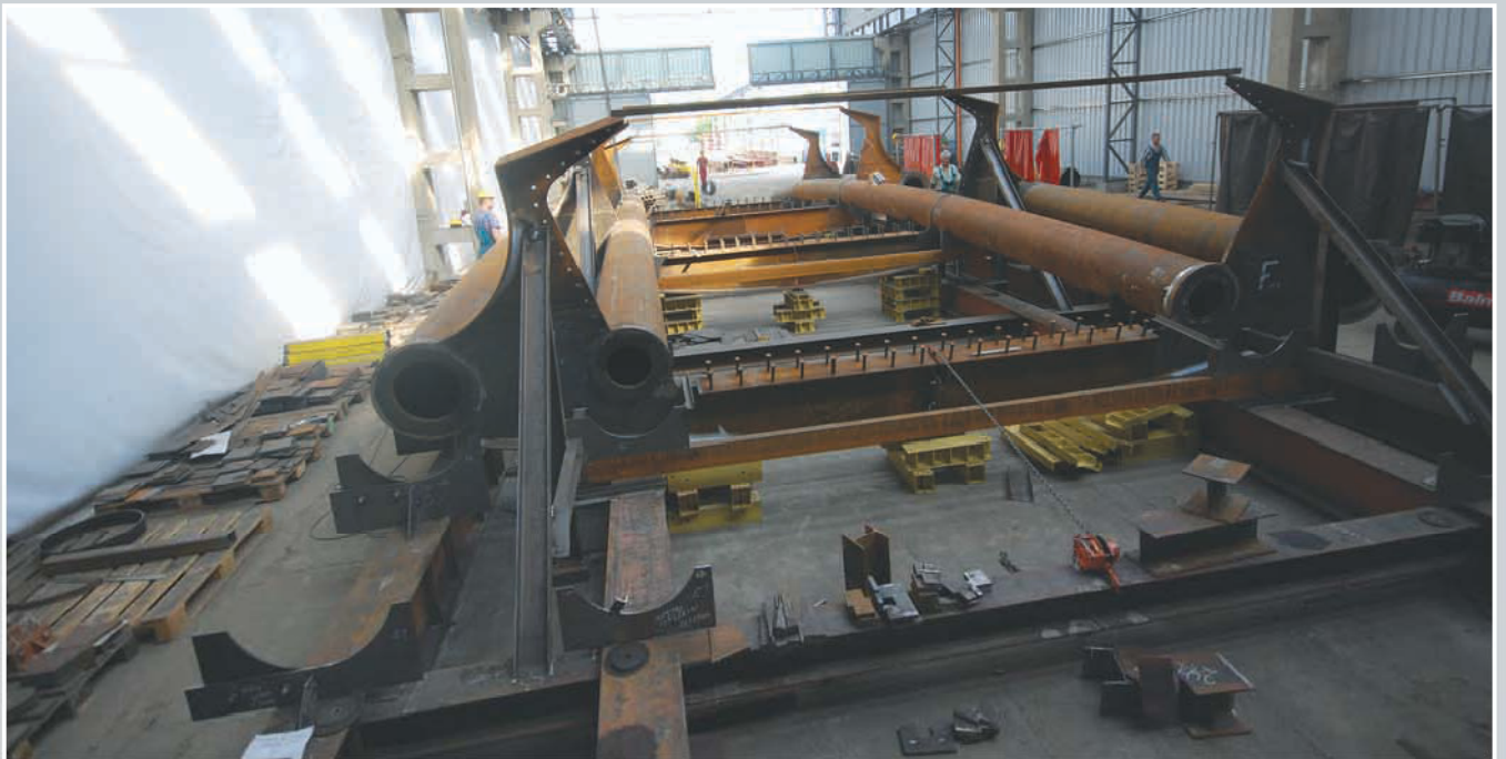
10. kép: Acélső ívet fogadó szerelvény elhelyezése a vasbeton cölöpösszefogóban
