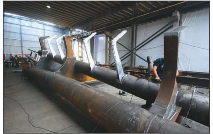
11. kép: Mindeközben a gyárban: acélsővek és egyedi formájú keresztartók összeillesztése
