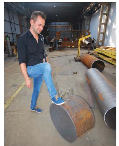
13. kép: A főtartó ív egy csődarabja: 610 mm átmérő, 12 mm falvastagság
