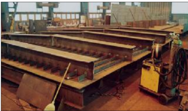
7. kép: Egy ortotrop pályaszerkezeti egység a műhelyben (fordított helyzetben)
