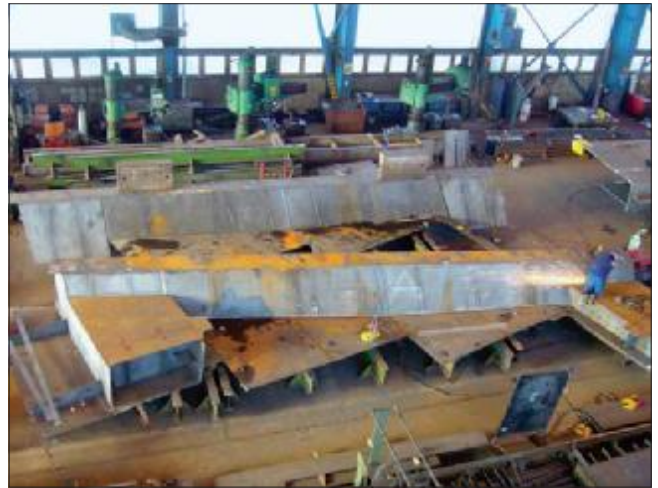
11. kép: A két végkereszttartó (fordított helyzetben)
