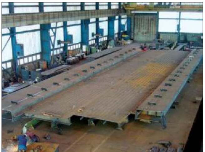
12. kép: Az üzemben próbaszerelt merevítőtartó (a végkereszttartók nélkül)
