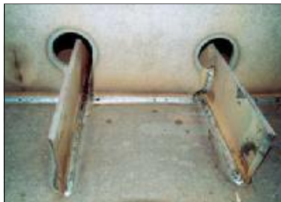
7. kép: Egy ortotrop pályaszerkezeti egység a műhelyben (fordított helyzetben)
