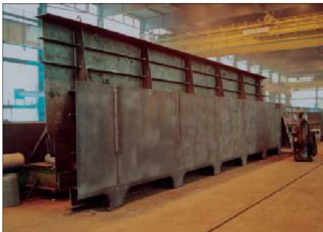
9. kép: Egy főtartó egység (a külső gerincre állított helyzetben)
