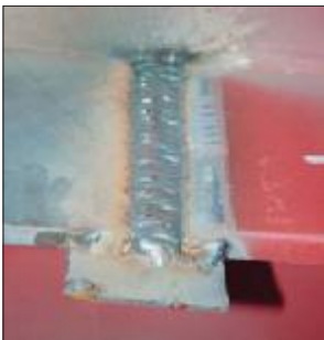
29. kép: A hosszborða illesztő- varratának fedősora
