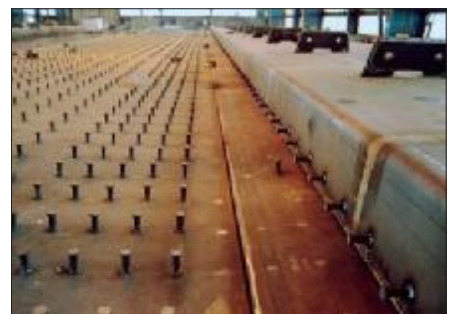
12. kép: Az üzemben próbaszerelt merevítőtartó (a végkereszttartók nélkül)
