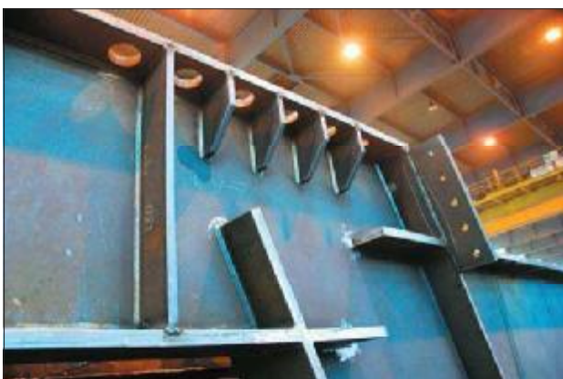
20. kép: Keretsarok-kialakítás és leborgonyzócsavar-lyukak
