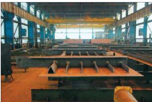
19. kép: Ortotrop pályatáblák gyártás alatt, megfigyelhető a zárt bordával merevített perem
