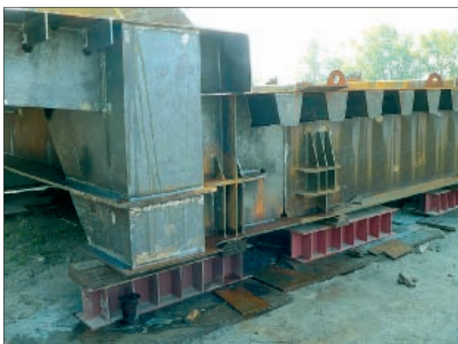
16. kép: Végkereszttartó gyártási egységek próbaillesztése hátulról, ideiglenes emelési pontok és mozgatóskori ideiglenes erőbevezetések merevítéseivel és a zárt „doboz” ívcsonkkal
