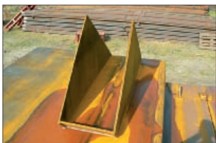
13. kép: Ívcsonk a végkereszttartó gyártási egységén
