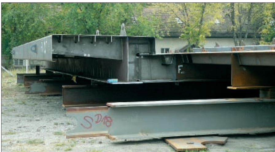
11. kép: Gyártási egységek próbaillesztései a KÖZGÉP Zrt. soroksári telephelyén
