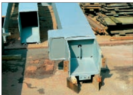
9. kép: Ívszerkezet gyártási egysége: látható a zárt „doboz” szerkezet, függesztőrúd csomólemeze, diafragma és kereszttartó csomk
