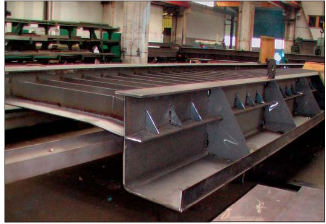
11. kép: Pályalemez gyártása
