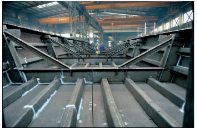
14. kép: A szekrény keresztmetszet próbaillesztése
